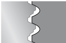
Резьба с осевыми дефектами обработки при использовании инструментов с правой спиралью: дефекты обработки на нижней поверхности профиля
