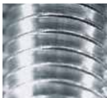
Гладкая поверхность при достаточной подаче СОЖ
