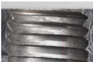
Осевые дефекты резьбы в сквозном отверстии
