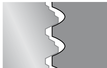
Резьба с осевыми дефектами обработки при использовании метчиков с левой спиралью или метчиков со спиральным заборным конусом: дефекты обработки на верхней поверхности профиля
