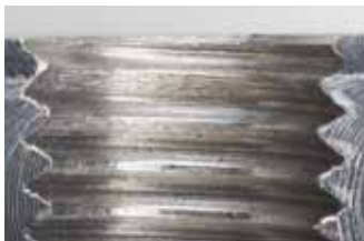
Осевые дефекты резьбы в глухом отверстии
