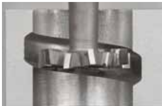
Наклон P=12 – искажение профиля
