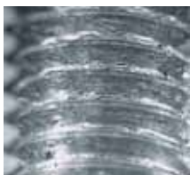
Задиры на поверхности резьбы из-за недостаточного количества СОЖ. Способ устранения: канавки для СОЖ
