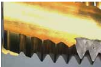
Пример: сколы из-за проблем со стружкообразованием
