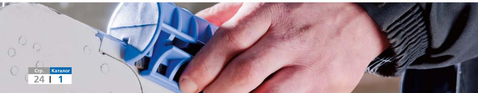
Фрезерованные напильники PFERD прекрасно подходят для грубого опилования. Фрезерованные зубья не забиваются за счет агрессивной формы с большими стружечными канавками.
