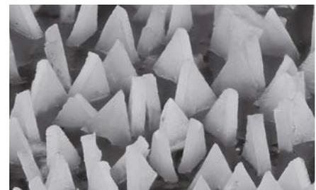
Оптимальное расположение абразивного зерна **VICTOGRAIN**
